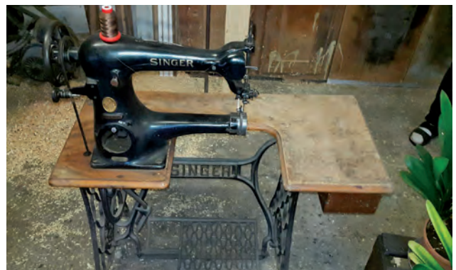
Schuhmacher-Nähmaschine für Leder
