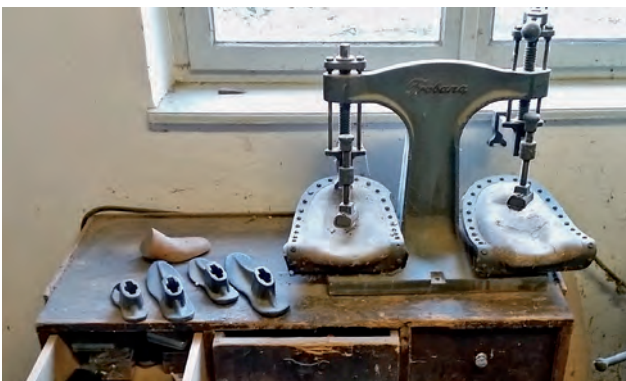
Mit dieser Presse wurden die Sohlen auf die Schuhe geklebt.
