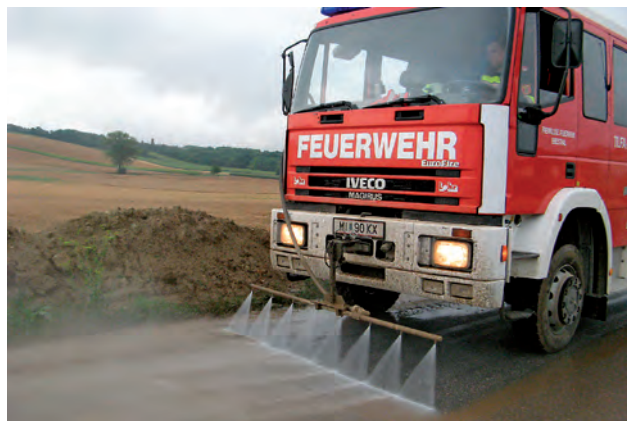
Straßenreinigung mit neuem Waschbalken des TLFA 2000
