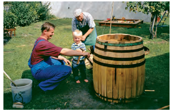
Aufziehen der Reifen bei der Herstellung eines Weinfasses
